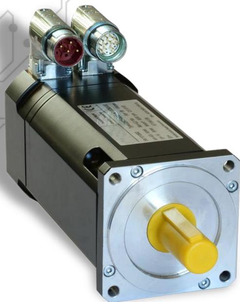
I servomotori brushless della serie **DSM5 - Taglia TRE** sono motori sincroni in AC. Utilizzano magneti dell'ultima generazione e si caratterizzano per il favorevole rapporto prestazioni/prezzo. Hanno un elevato rapporto coppia/volume e forniscono ottime prestazioni dinamiche, con basso ripple di coppia. Possono montare un resolver oppure un encoder di tipo incrementale, assoluto o sin-cos.
